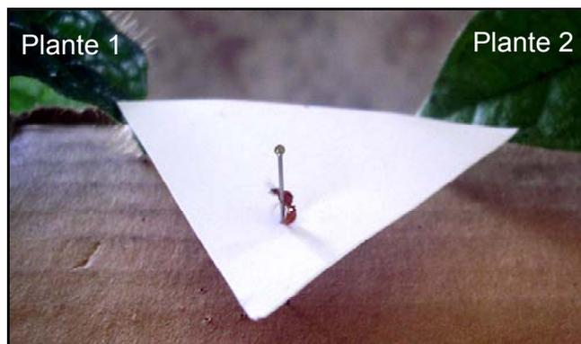
**Figure 48.** Dispositif utilisé dans les tests de choix. Une reine d'*A. decemarticulatus* vient d'être déposée sur l'épingle.
